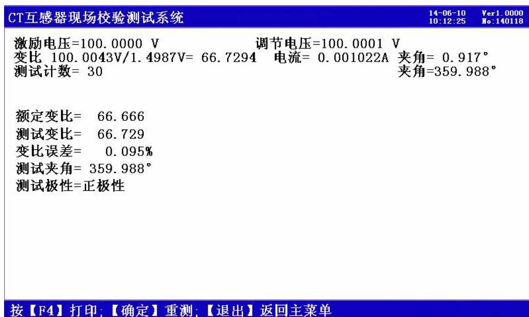
图 13、PT 变比极性测试结果界面
