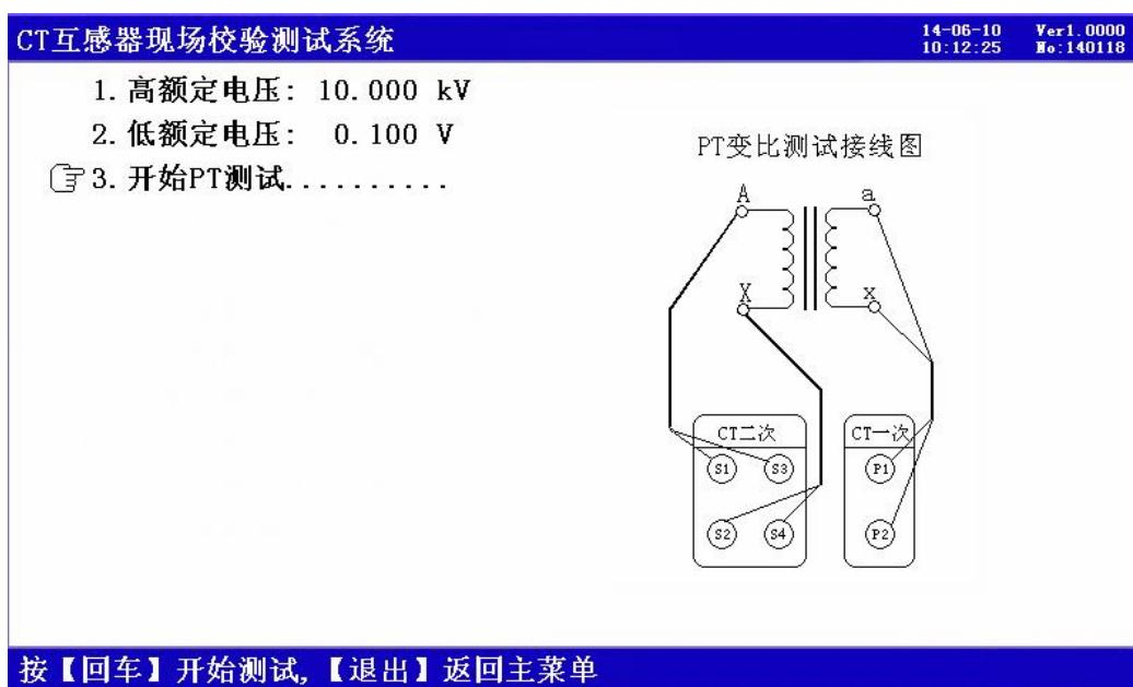
图 12、PT 变比极性设置接线提示界面
