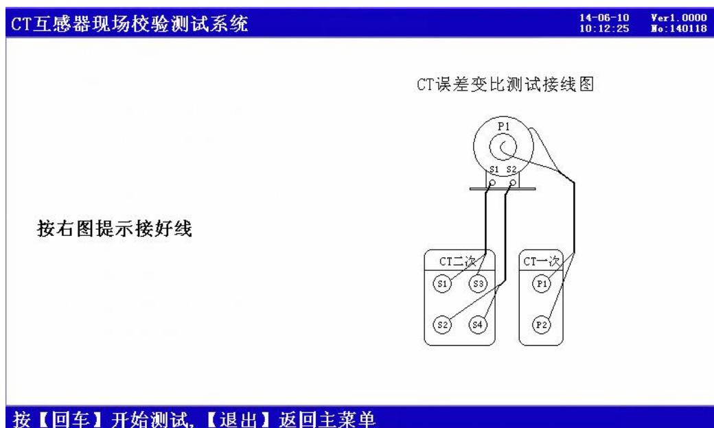
图 10、CT 变比粗测接线提示界面
