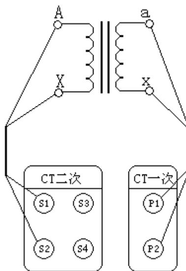
图 18、PT 变比极性测试接线示意图
