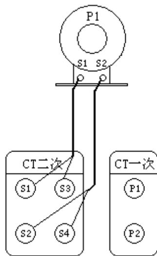
图 17、CT 直阻测试接线示意图
