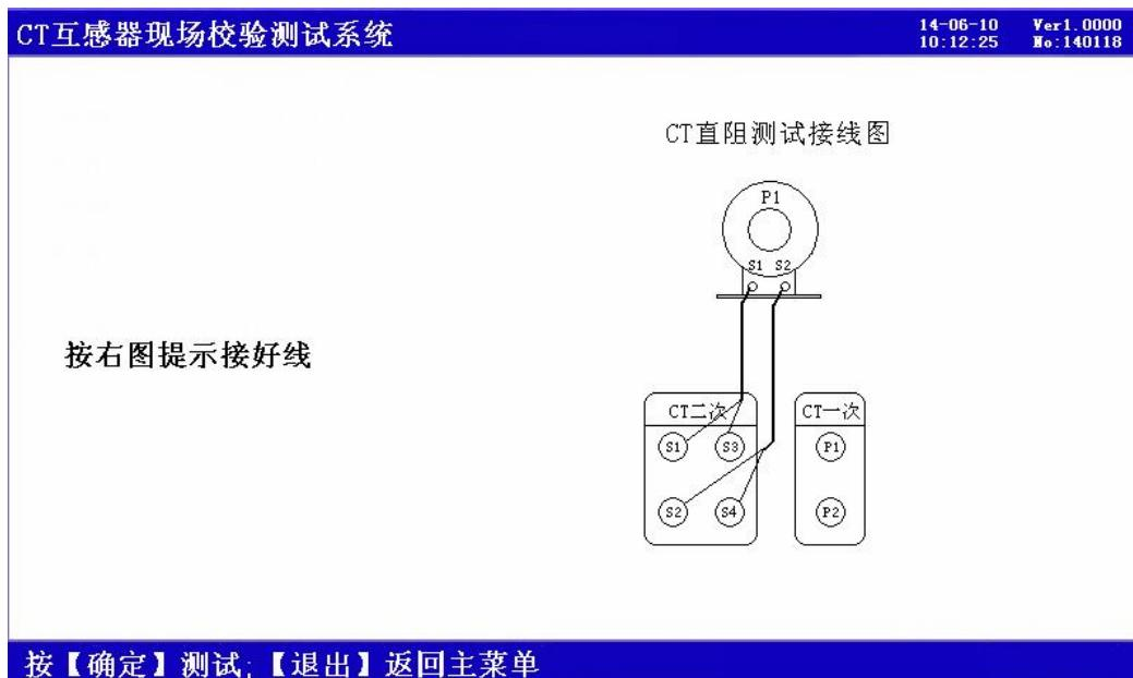
图 8、CT 直阻测试接线提示界面
