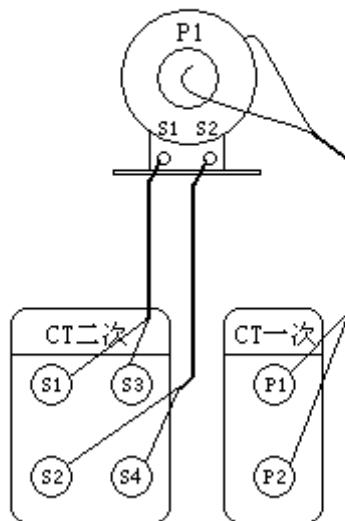
图 16、CT 校验接线示意图
